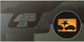
●e-Assist (低車速域衝突被害軽減ブレーキシステム[FoCM-City]、誤発進抑制機能(前進時))
